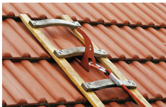
obr. 2.47 Bezpečnostní střešní hák dle ČSN EN 517 k jistění jedné osoby a položení žebříku do 3m
